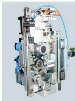
**Cabeçote para Arqueação com Fita de Aço Modelo VS11/12**
