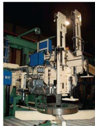
Suportes elevatórios e rotativos eliminam a ocorrência de danos à bobina.
